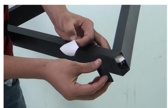
9: umieść kwadratowe podkładki antypoślizgowe na dole nóg stołu (aby zapobiec zarysowaniu podłogi)
