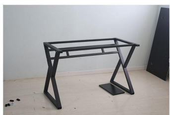
6: przymocuj kolejną pojedynczą poprzeczkę do nóg stołu za pomocą długich śrub
